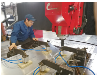
长春工业大学研究项目搅拌摩擦焊先进制造技术应用于高铁车钩座、连接板、裙板、顶板等关键零部件的制造。
