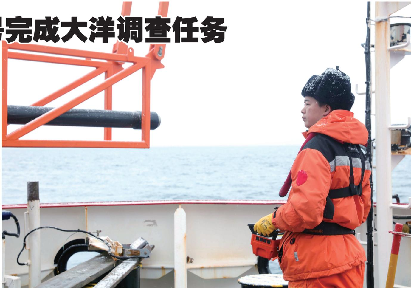
2月9日,“雪龙2”号副水手长何群在操控重力柱释放。垂直触底后,重力柱将收集海底沉积物样本以供研究。
