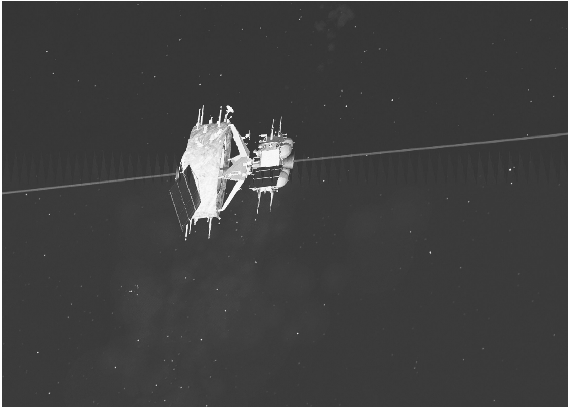
6月6日在北京航天飞行控制中心大屏幕上拍摄的嫦娥六号月球轨道交会对接与在轨样品转移动画模拟画面。 新华社记者 金立旺 摄
