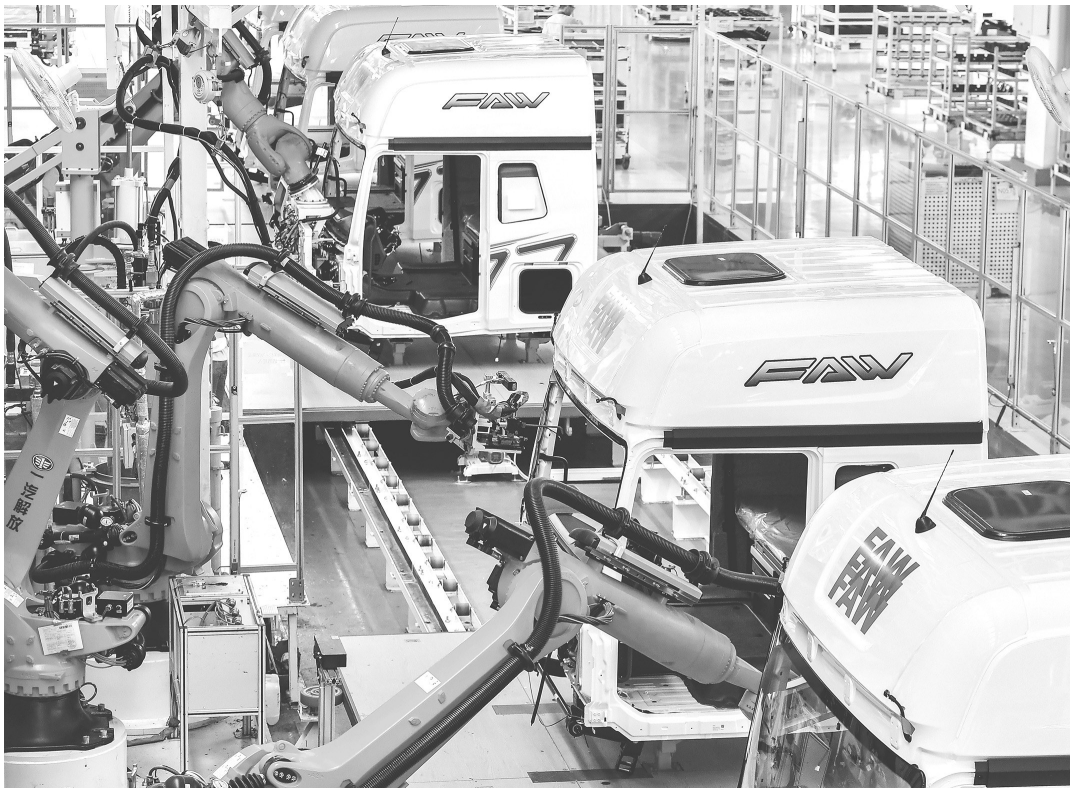
在位于吉林长春的一汽解放J7智能工厂内,智能机器人进行车辆玻璃装配及涂胶工作(2023年6月27日摄)。
