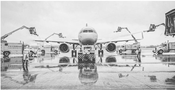
机身整体开展除冰 吉林机场集团供图
