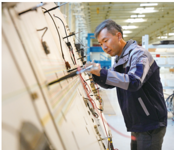
3月14日,杨世谊在制作旋翼机整机线束。 新华社记者 李安 摄
