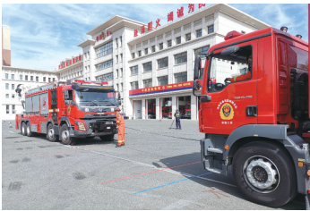
抢险救援车路障排除,牵引障碍物
