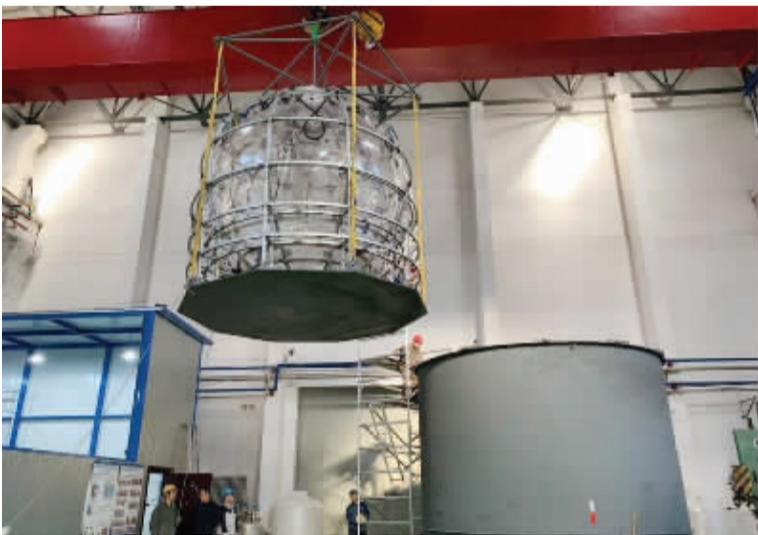
为确保12层楼高大球的设计安全无误,科研人员先造出直径3米的小球,进行模拟实验。图为小球模型吊装。
