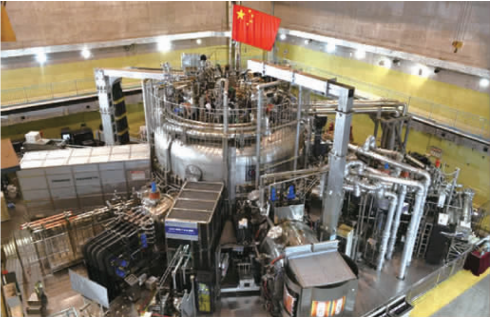
这是位于科学岛上的中国自主研发的世界首台非圆截面全超导托卡马克实验装置东方超环 EAST
