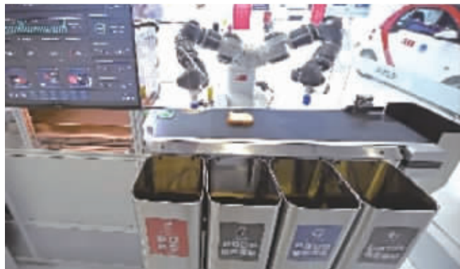
第二届进博会瑞士ABB集团展台拍摄的全自动垃圾分类设备
